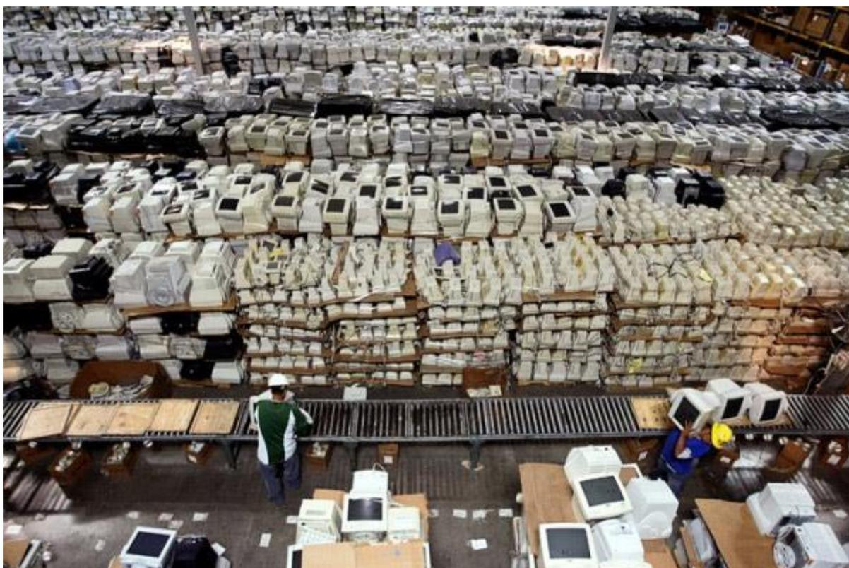
Первый этап всегда производится вручную. Это – удаление всех опасных компонентов из компьютеров и техники, выпущенных в конце 90-х начале 2000-х годов. В кинескопных мониторах этой техники содержится немало соединений свинца. Другая категория продукции, содержащая опасные элементы, – ноутбуки. В аккумуляторах и экранах устаревших моделей имеется определенное количество ртути, которая также очень опасна для организма (в новых моделях ноутбуков от этих вредоносных компонентов избавились).
